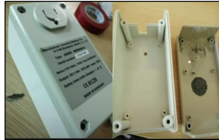
Figura 1. Modelo inicial: fracturas y reparaciones anteriores.
